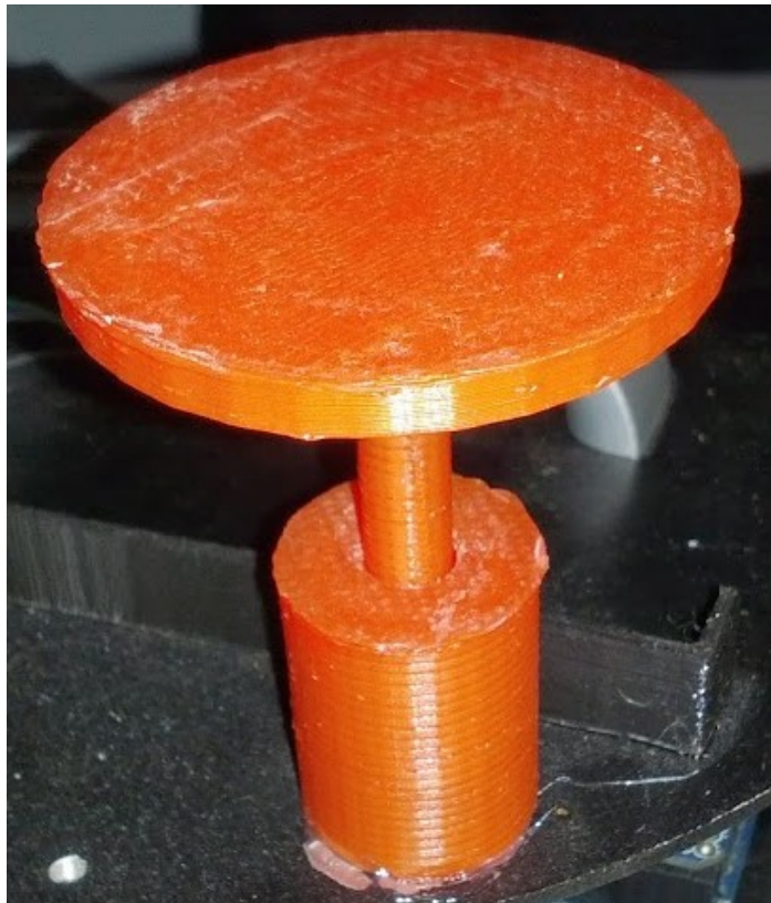
Ilustrace 16: Nouzový vypínač namontovaný na robotovi
