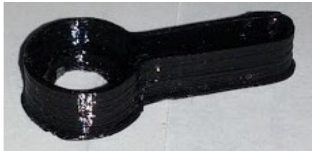
Ilustrace 19: vytištěný držák ložiska
