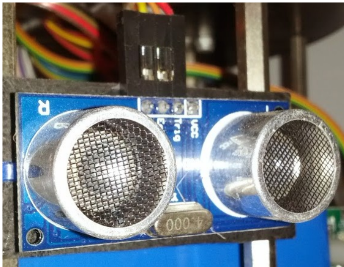
Ilustrace 26: Ultrazvukový senzor umístěný v zadní části robota
