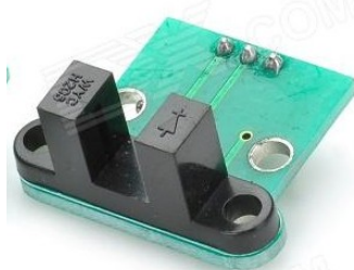
Ilustrace 5: Modul enkodéru, zdroj http://dx.com
