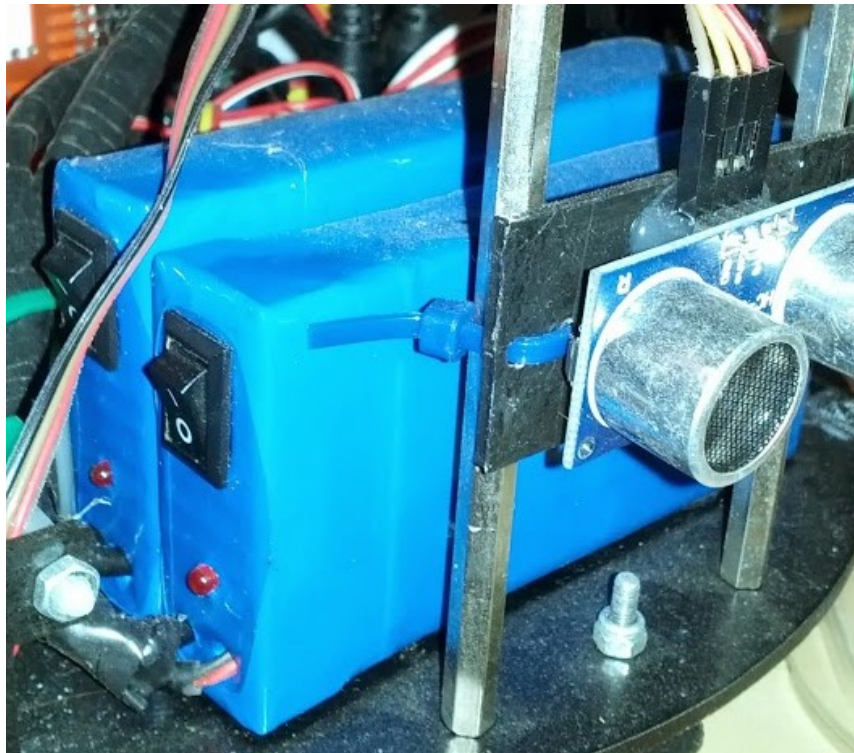
Ilustrace 20: Dva akumulátory namontované na robotovi
