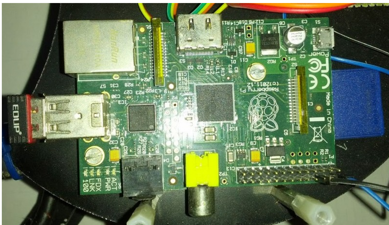
Ilustrace 31: Řídicí jednotka RaspberryPI® namontovaná na robotovi
