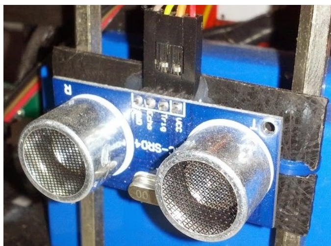
Ilustrace 15: Držák se senzorem namontovaný na robotovi
